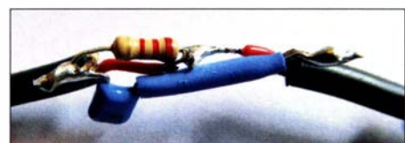
Bild 7: PTT-Widerstand und Abblockkondensator in Kabelmontage
