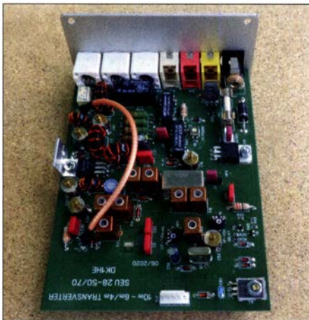
Bild 7: Oberseite der vollständig bestückten Leiterplatte des Transverters SEU 28-50 mit montierter Frontplatte Foto: DK1HE
