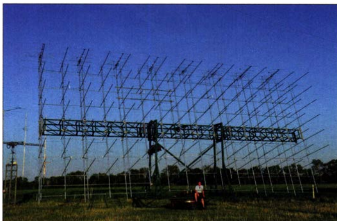
Mit seiner Gruppe von 128 11-Element-Yagi-Antennen verfügt DL7APV über fast 34 dBd Gewinn. Der horizontale Öffnungswinkel beträgt nur 1,8° – da muss man gut aufpassen, um nicht am QSO-Partner vorbeizustrahlen, s. a. FA 4 und 5/2019.
